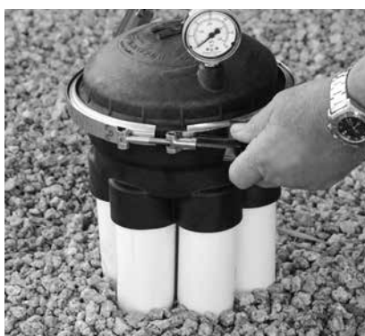
8. Pendant que vous serrez la clampes frappez légèrement avec un tourne vis
