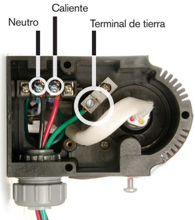
**Cableado para 120v:** Conecte el cable neutro al poste izquierdo, el cable caliente al poste derecho y el cable verde a tierra al terminal de conexión a tierra.
